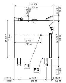
Electrical inlet (power) EQ Equipotential screw
